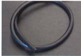
4mm バキュームホース ¥900/1m ブースト計やディスビのパキューム等に使用できる。
