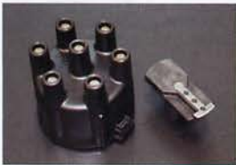
ディスクキャップ&ローターセット 純正フルトリスビ用 適合: S31, S130 (前期) GC111, GC210 価格: ¥5,450/SET
