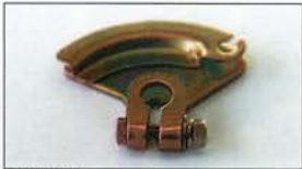
●オオギレバー (軸径：8φ 10φあり) 本体 ¥1,900 ワイヤー式でスロットルを作動させるレバー。日産用、トヨタ用あり。
