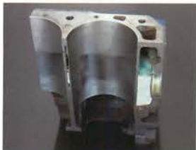
※ブロックフィラー作業順序 3 注入量は目的により異なります。ドラックレースは上面から80~85mm、周囲レースは90~95mmくらいが目安です。ブロックフィラーを入れた分だけ冷却水の容量が減り水温や油温に影響を与えるので目的に応じた量が必要です。
