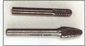
超硬バー (燃焼室加工用) (6φ軸)
