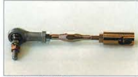
●ターンバックル (片ピロ) 本体 ¥3,100 ソレックスの場合はキャブ側のボールが外れないため片ピロタイプがとっても簡単。
