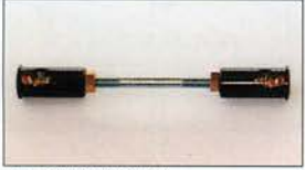
●ターンバックル (ブラック) 製造廃止 インマニに標準的に付属されているアフターパーツでブラックの部分はプラスチックで出来ている。
