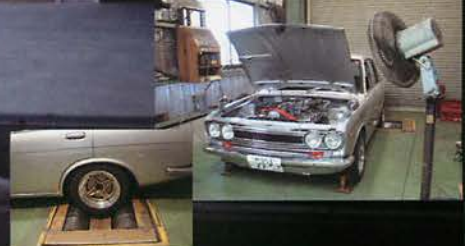
BOSCHシャーシーグイナモによるパーツの性能試験
