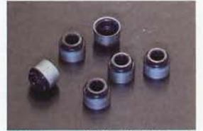
L型 ローヘッドバルブオイルシール ¥270/1ヶ 純正品より1.3mm高さが低いタイプ。底付きまでの距離をかせげて、バルブリフトをあげられる。
