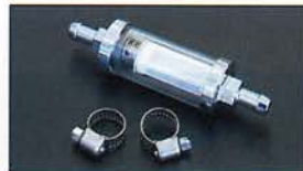
●マグネット付燃料フィルター 本体 ¥3,500 ※分解清掃可能なガラス管タイプのフィルターで、内部に仕込まれたマグネットがサビや粉塵をキャッチします。(ホースバンド2個付属)
