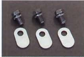
L6 カムホルダーオイルシャワープラグ ¥1,200/SET ・L型前期型エンジンにセンター給油カムを装着した時に必要なオイル通路栓。
